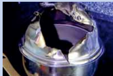
Riskant: Geborstener Durotherm-Topf von Kuhn Rikon
