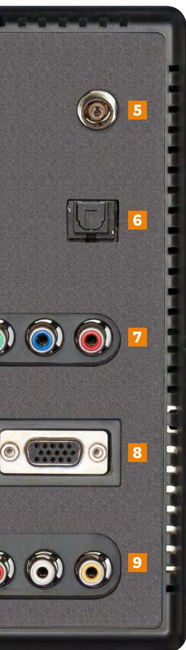
**5 Antennenbuchse:** Falls man TV via Kabelanschluss sieht, muss man hier das Kabel einstecken. Allgemein gilt: Je dicker das Kabel, desto besser. Kupferkabel sind gut geeignet.
