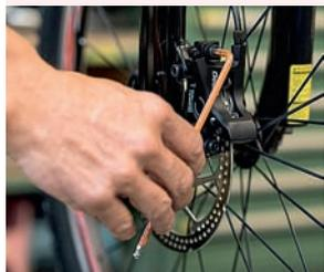
**1.** Bremszangenschrauben lösen – und zwar so weit, dass die Bremsbacke leicht bewegt werden kann
