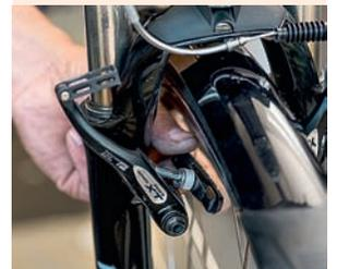
4. Neuen Bremsklotz einsetzen, verschrauben und gegen die Felge drücken. Darauf achten, dass der Bremsklotz in der Mitte der Felge zu liegen kommt
