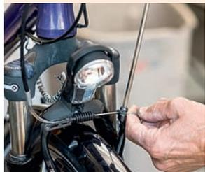
**7.** Mit einer Hand am Seilende ziehen, bis der Bremsklotz 3 bis 4 mm von der Felge entfernt ist. Mit der anderen Hand die Seilklemmschraube festziehen, Vorspannfeder einhängen
