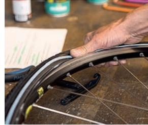
11. Den Pneuulst in die Felge hineindrücken. Tipp: Falls sich der Pneu am Schluss schwer aufsetzen lässt, die Felge mit Seifenwasser beschmieren
