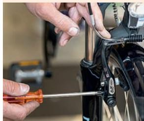
**8.** Falls sich die Bremse auf einer Seite stärker zur Felge bewegt: Mit der Einstellschraube die Federvorspannung regulieren
