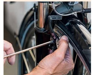
3. Mit dem Schlüssel die Bremsklotz-Inbusschraube lösen, damit sie sich herausnehmen lässt
