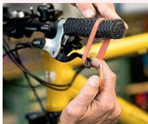
**2.** Dann die Bremse fest anziehen und mit einem Gummiband den Hebel in dieser Position fixieren
