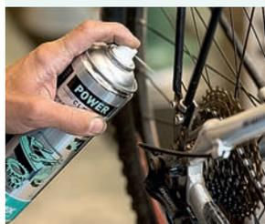
**1.** Altes Fett und Schmutz mit Seifenlauge oder Kettenreiniger lösen. Den Antriebsstrang einschäumen, Schaum einwirken lassen und mit einer Bürste schrubben
