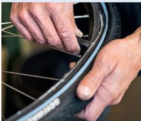
2. Pneuheber ansetzen und entlang der Felge ziehen, Pneu abziehen und Schlauch entnehmen
