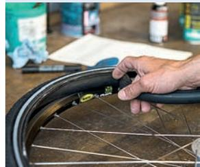
10. Schlauch leicht aufpumpen und in die Felge einlegen
