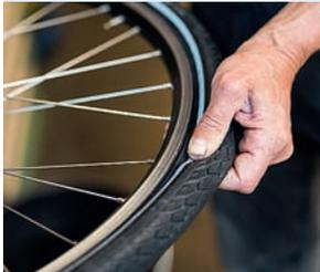
1. Mutter am Ventil entfernen. Pneu gegen die Mitte der Felge drücken
