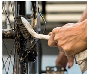
**2.** Die Kurbel drehen, mit der Bürste die Kassettenritzel reinigen
