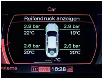
Display: Am Steuer ist man jederzeit über den Reifendruck informiert
