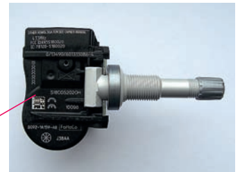
Sensoren am Pneuventil: Sie übertragen die Messresultate per Funk aufs Display im Auto
