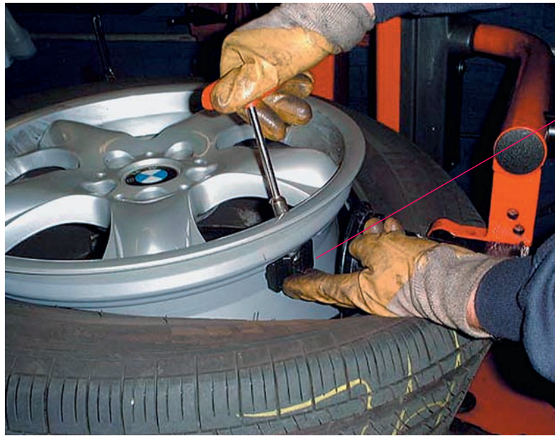
Sensoren am Pneuventil: Sie übertragen die Messresultate per Funk aufs Display im Auto
