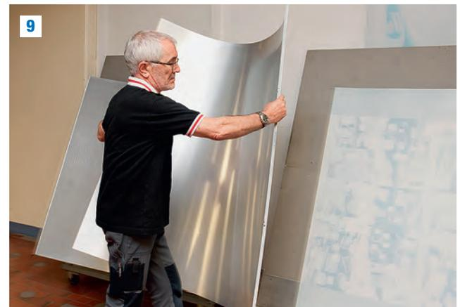
**Druckplatten:** Meinrad Rohrer bereitet die mit den K-Tipp-Seiten belichteten Platten für den Druck vor
